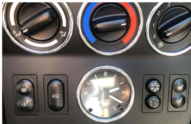
Zu wissen ist, der Schalter für das ASC benötigt ein vier-adriges Kabel zur Verlängerung, der Schalter für das elektrische Verdeck benötigt fünf Adern. Da ich kein vier- oder fünf-adriges Kabel hatte, habe ich einzelne Litzen mit einem Querschnitt von  $0,75\text{mm}^2$  genommen und sie ein wenig verdrillt.
