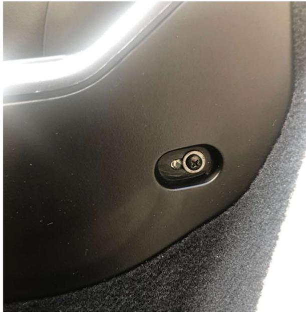
Im vorderen Bereich sind rechts und links je zwei Schrauben zu lösen. Sie sind mit kleinen Plastikkappen verdeckt, die man mit einem kleinen Schraubenzieher leicht entfernen kann.
