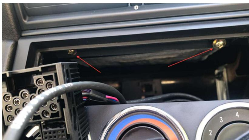
Je eine Schraube rechts und links. Diese Befestigen die Heizungseinstellung an der Mittelkonsole.
