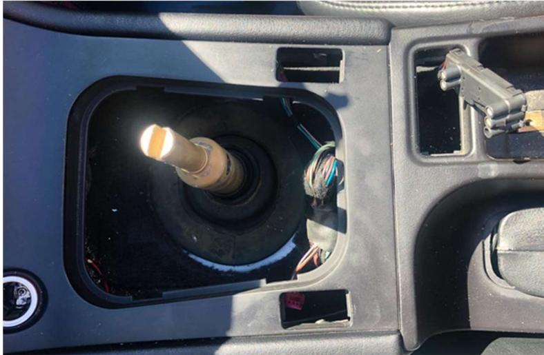
Die Schalter aus der Blende im hinteren Bereich sind nun dran. Ich habe die ganze Platte ausgeclipst. Dazu mit einem Plastikkeil (notfalls auch Schraubenzieher) zwischen Konsole und Platte gehen und nach oben aushebeln.
