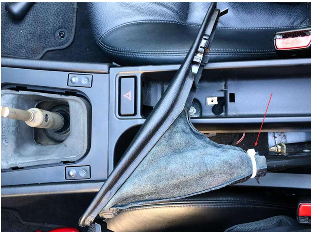
Nun den Schaltknauf nach oben wegziehen (ist auch nur geklemmt) und die Schalthebelverkleidung (Lederbalg) ausclipsen.
