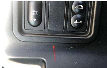
Die Platte ist mit einem Rahmen, der unter der Konsole liegt, an vier Stellen "verclipst". Im nächsten Bild mit zwei Pfeilen markiert:
